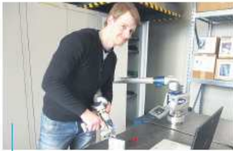
Der Mann für komplizierte Formen: Daniel Gaetcke demonstriert den Einsatz des 3-D-Scanners. Er verantwortet bei vdh auch die Qualitätssicherung und die Ausbildung mit derzeit zehn Azubis aus den Berufen Zerspanungsmechaniker, Industriemechaniker und Mechatroniker. Sein Kollege Marc Lichtmess kümmert sich zudem um die Vor- und Nachbereitung der Berufsschulthemen und die Prüfungsvorbereitung.
