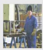
Geradezu virtuos geht Timo Brandt mit seinem MAG-Schweißgerät um. Gerade arbeitet er an einem Grundgestell für eine Felgenprüfanlage. Die Funken fliegen. "Wir arbeiten hier auf einem sehr hohen Qualitätsstandard", sagt Timo Brandt, nachdem er die Schutzmaske nach oben geschoben hat. Der 29-Jährige ist gelemter Industriemechaniker, der Besuch mehrerer Weiterbildungen hat ihn zu einem richtig guten Schweißer gemacht. "Ich bin sehr froh, diese Aufgabe hier übernehmen zu dürfen", sagt er.
